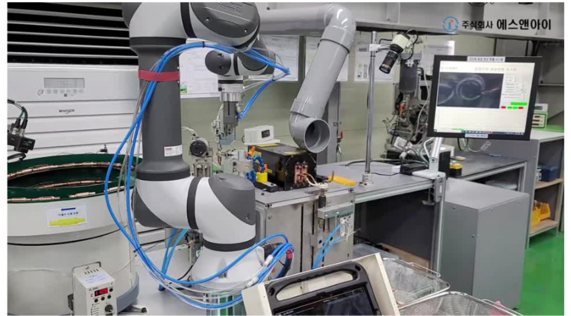
조립·용접 작업부와 비전 모니터
